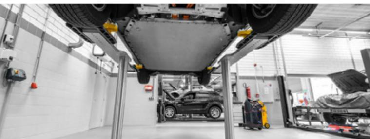
Die Masterlift 2.35 Combi mit Kolbenabstand (KA) 1700 ist die perfekte Bühne für Ihren Annahmehbereich und für einfache Reparaturarbeiten. Darüber hinaus kann sie durch die Pv Lastaufnahme 180-240 die derzeit gängigsten Elektrofahrzeug-Modelle sicher anheben.
