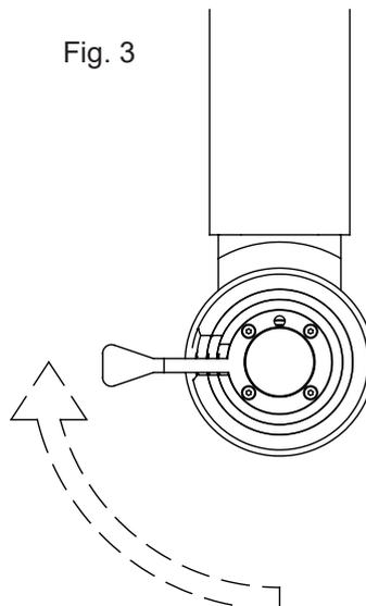
**Kontrolle der Vorspannung des Feders:**
