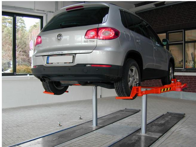
**Abb. 5: Einsatz von Radgreiferaufnahmen**
