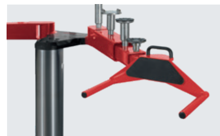
Lastaufnahme mit Steckpilzen und Radgreifern
