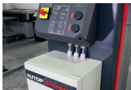
DT Steuerung und Schaltschrank
