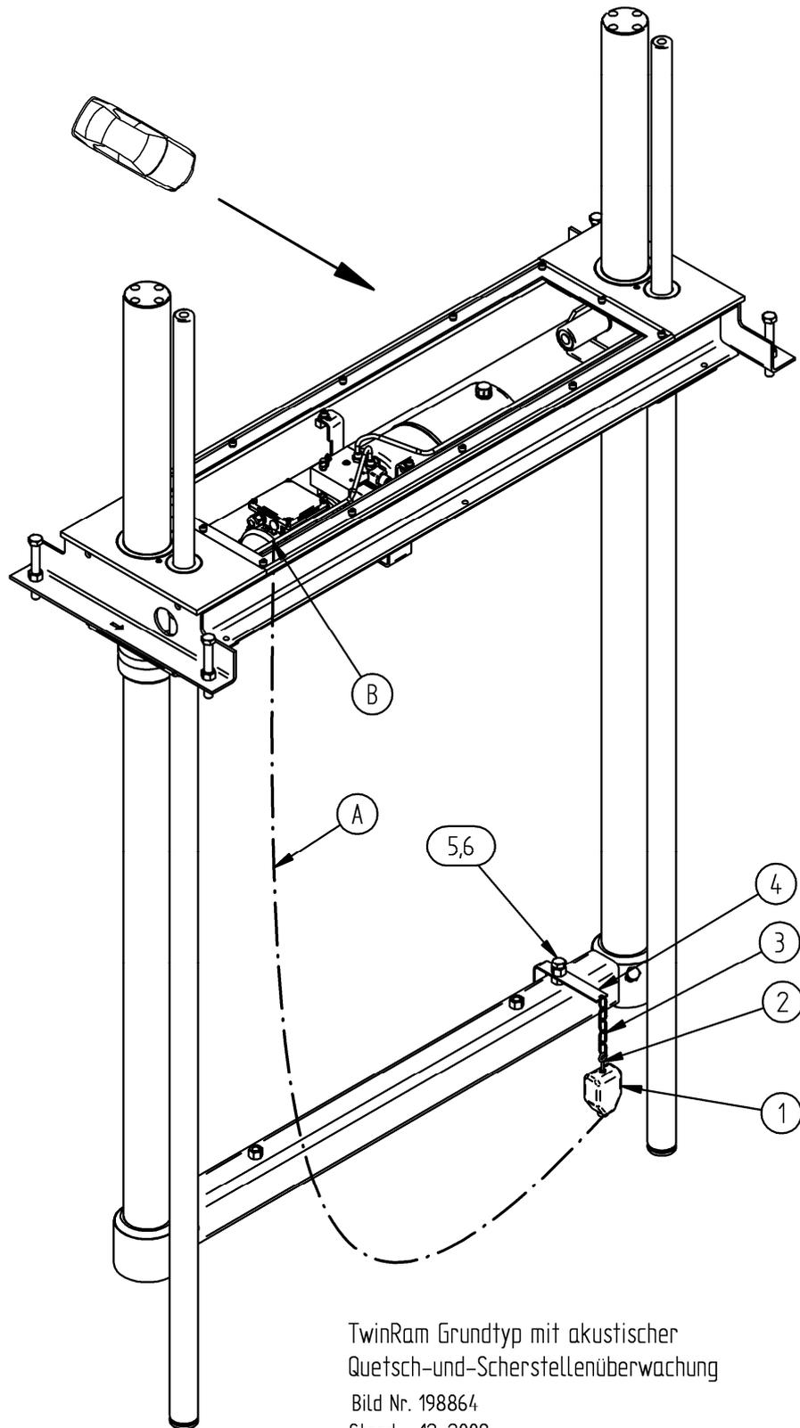
**Legende:** A – Hängekabel; B – Hängekabel mit Kabelbinder an der Rohrleitung befestigen.
