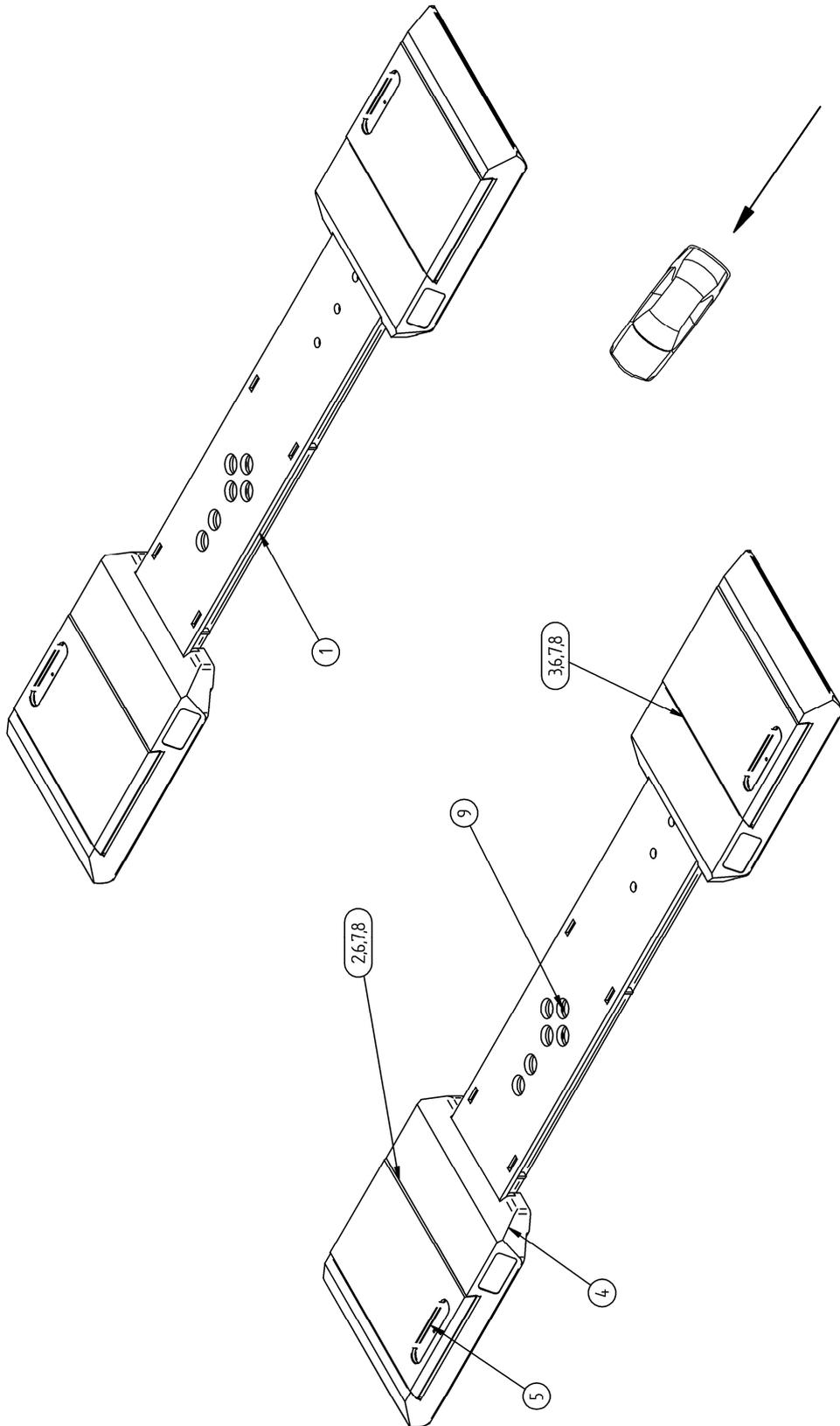
Plattenaufnahmen längs und quer verstellbar
