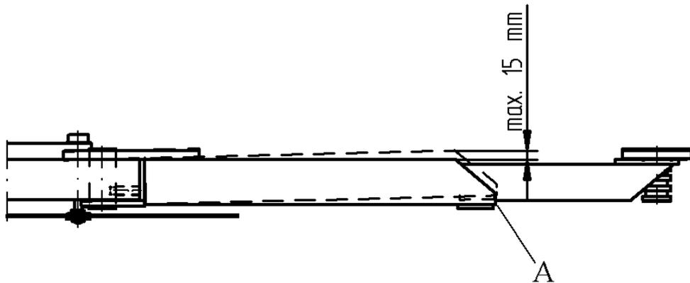
Beim Anheben und Absenken der Schwenkarme von Hand darf der Ausschlag max. 15 mm betragen. Bei Überschreitung sind die Arme auszutauschen.
