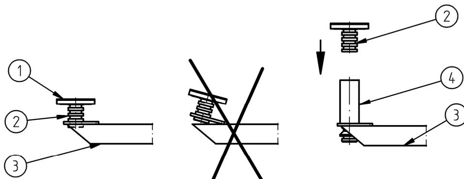
**Legende:** 1 – Gummiauflage; 2 – Steckaufnahme; 3 – Aufnahmeschieber; 4 - Zusatzaufsteckteil
