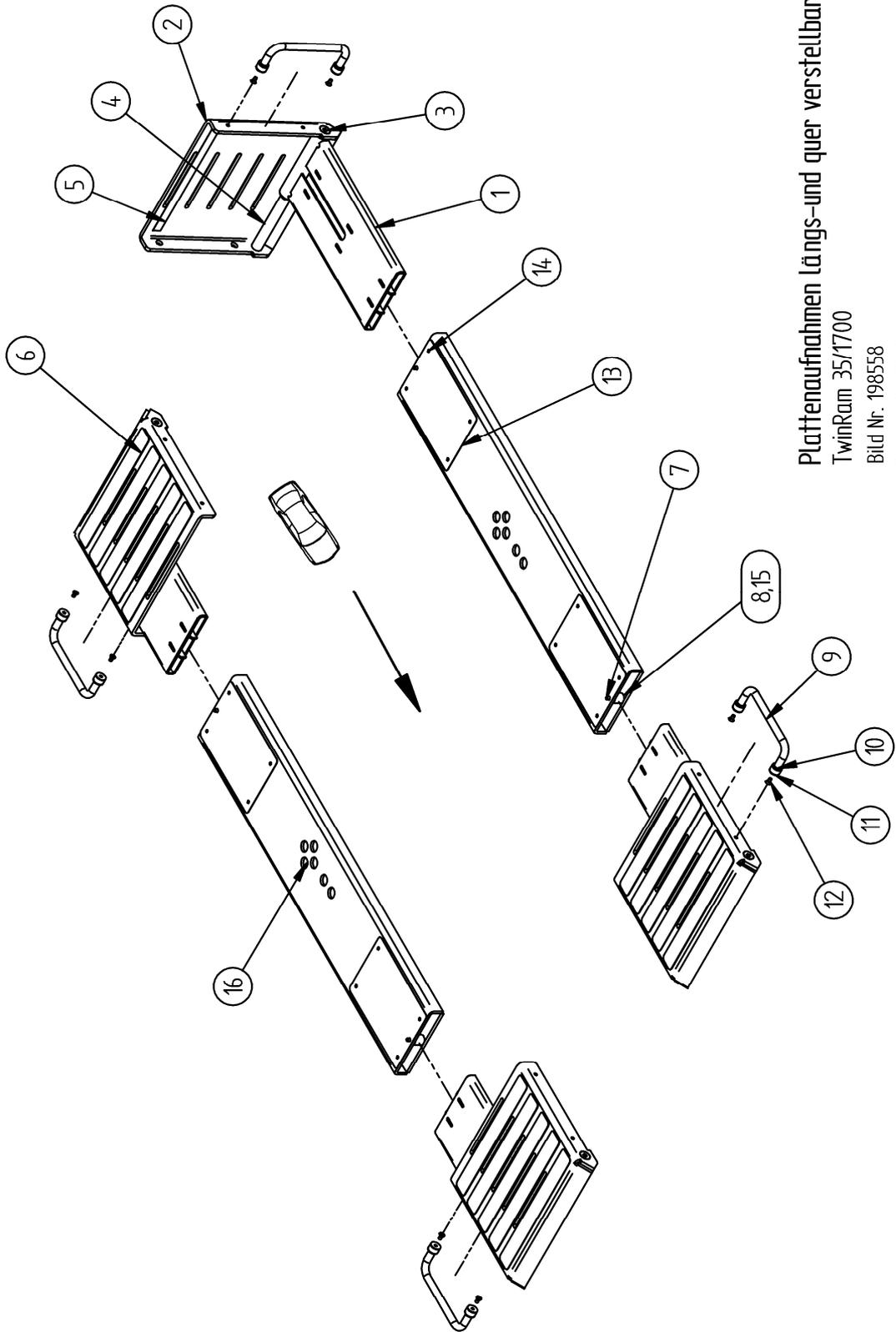
Plattenaufnahmen längs-und quer verstellbar
