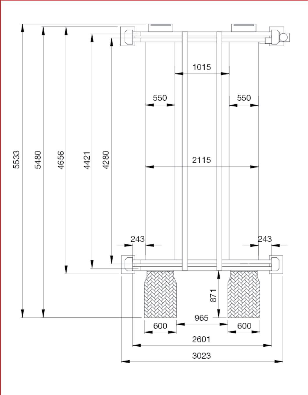
**Massskizze: Modell H4543** (5 Tonnen Tragkraft)
