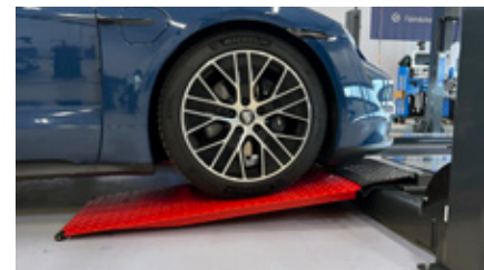
Lange Auffahrrampen für flache Fahrzeuge (optional)
