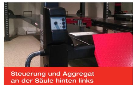
Steuerung und Aggregat an der Säule hinten links
