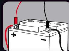
Anschliessen des Ladegerätes an die Batterie durch fest installierte Ösen.
