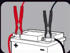
Anschliessen des Ladegerätes an die Batterie mittels Klemmen.
