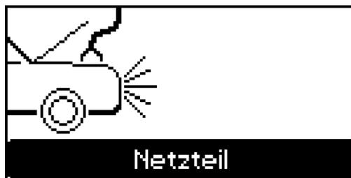
Der Netzteil-Modus ermöglicht eine Stromversorgung des Fahrzeuges, während Reparaturarbeiten bei ausgebaute Batterie.
