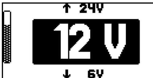
Das Ladegerät erkennt die angeschlossene Batterie automatisch, z.B. 12 V und startet den Ladevorgang nach ca. 5 s.
