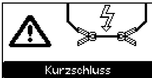
Kurzschluss der Ladeklemmen oder des Ladekabels, Kurzschluss-Erkennung aktiv
