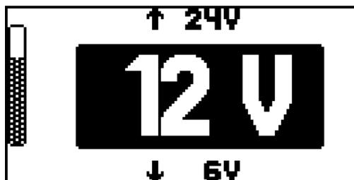
Das Ladegerät erkennt die angeschlossene Batterie automatisch, z.B. 12 V und startet den Puffervorgang nach 5 s.
