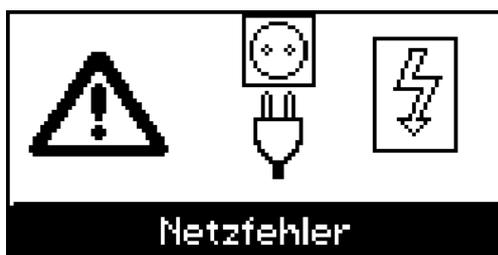
Netzfehler - Netzspannung außerhalb des Toleranzbereiches
