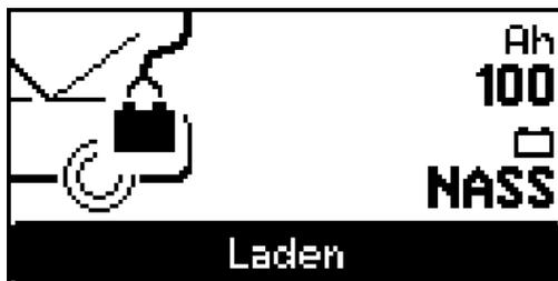
Die Betriebsart Laden steht nach dem Anschließen des Ladegerätes am Netz standardmäßig zur Verfügung.
