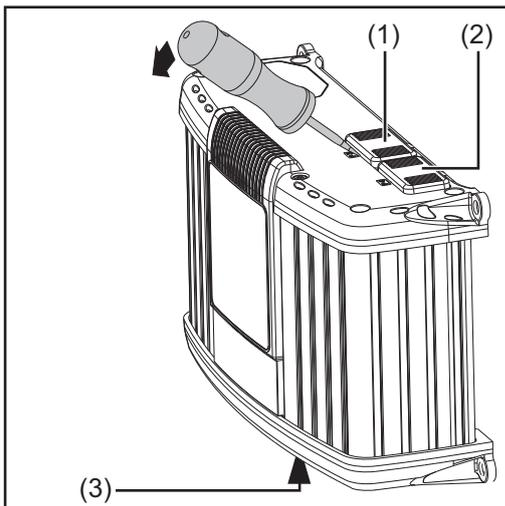
Falls erforderlich, mittels Schraubendreher entfernen:
