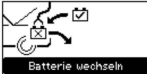
Die Betriebsart Batterie-Wechsel ermöglicht eine unterbrechungsfreie Stromversorgung der Bordelektronik bei einem Wechsel der Batterie.
