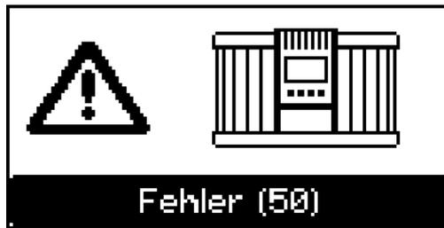
Nr. 50: Ausgangssicherung des Gerätes defekt
