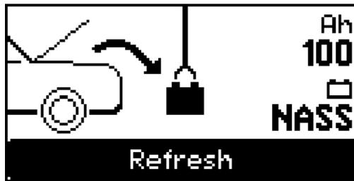
Die Betriebsart Refresh dient dem Reaktivieren tiefentladener oder sulfatierter Batterien. Die Refresh-Ladung erfolgt an der ausgebauten Batterie, im Freien oder in gut belüfteten Räumen.
