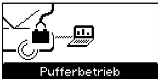
Der Pufferbetrieb entlastet die Fahrzeug-Batterie während einer Diagnose oder eines Software-Updates am Fahrzeug.
