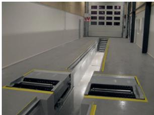
Der BM17200 ist ein Rollenprüfstand für leichte und schwere Fahrzeuge mit einer Kapazität von Prüfachslasten bis zu 16.000 kg Achslast (optional 20.000 kg).
