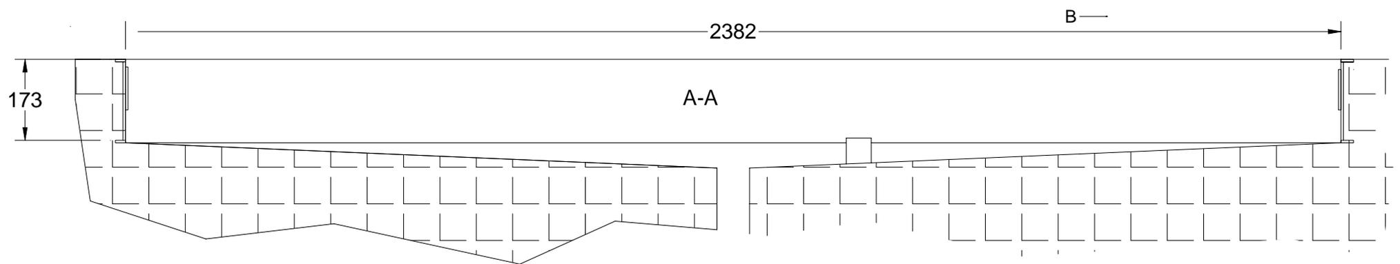
Fundamentplan für BM3010 mit Rollenlänge 700 mm,
