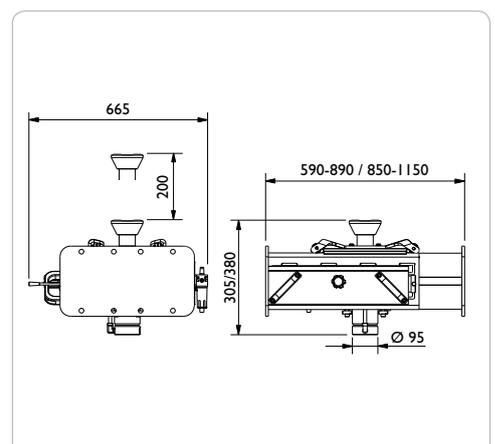
\* Die Kapazität des Achsfreihebers darf 0,66 x Kapazität der Hebebühne nicht überschreiten
