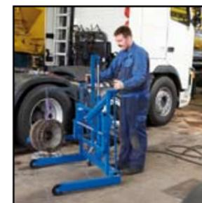
Für die Demontage von Bremscheiben - ermöglicht ergonomisches Arbeiten
