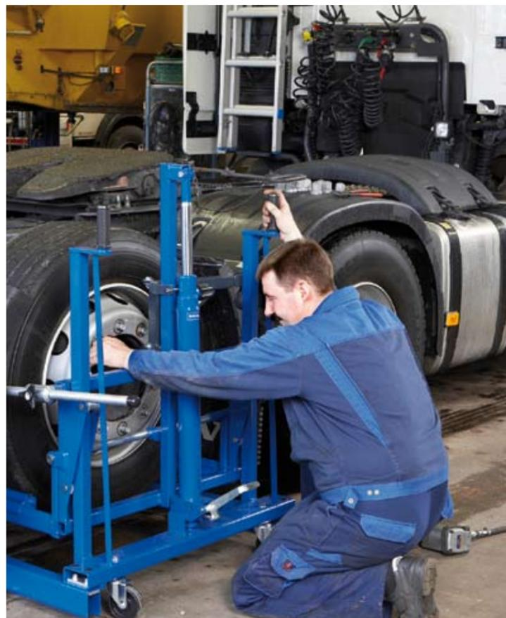
Bremsenkits, montiert werden. Auch für viele andere Hubaufgaben geeignet. Tragfähigkeit des Kranarms ist 250 kg.
