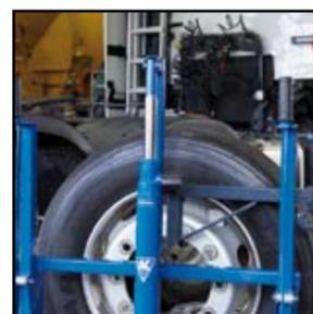
Schwenkbarer Teleskoparm, um Demontage zu vermeiden (Zubehör)
