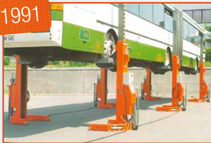
EHB 705: Hydraulische Radgreifer, Direktantrieb mit Hubschlitten nach oben ausfahrend
