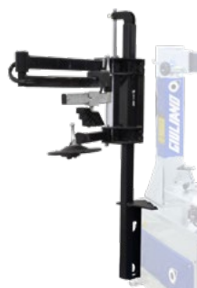
PRESS ARM ECO Hilfsarm zur leichteren Ausführung der Auf- und Abziehvorgänge bei Niederquerschnittsreifen und UHP-Reifen. (nur für die SL22 Version erhältlich).
