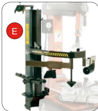
**IT** **DISPOSITIVO PNEUMATICO UNIVERSALE UPH & BPS (OPTIONAL):** Attrezzatura pneumatica ausiliaria UPH che assiste l'operatore durante il montaggio e lo smontaggio di ruote ribassate o particolarmente difficili come le «Run-Flat». Tale dispositivo brevettato evita di dover utilizzare la leva durante lo smontaggio del secondo tallone. Altri dispositivi di aiuto a posizionamento destro (SPH o TPH) sono, inoltre, disponibili su richiesta.
