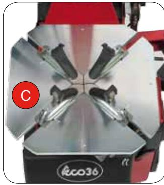
**IT** **PIATTO AUTOCENTRANTE:** Sistema che permette di serrare cerchi da 10" a 25" senza regolazioni né adattatori: capacità di serraggio interno 10"-22", esterno 13"-25". La speciale geometria del gruppo di serraggio griffe dotato di bielle curve permette di mantenere costante la forza di bloccaggio al variare del diametro del cerchio.
