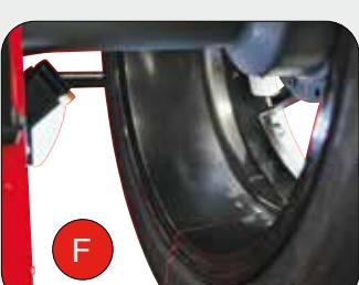
**(IT) «Kit LASER & LIGHT»:** Illuminatore cerchio e linea Laser, disponibile sia per TECO 670 che per TECO 670 PLUS (optional). Il sistema Laser assiste l'operatore durante il posizionamento del peso adesivo ad ore 6 durante l'utilizzo dei programmi ALU.
