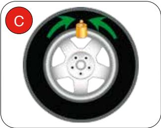
**(IT) RICERCA AUTOMATICA POSIZIONE DI EQUILIBRATURA:** Sistema di lancio a cinghia a velocità variabile e bloccaggio elettronico dell'albero porta-ruota. Al termine del lancio, la macchina posiziona automaticamente la ruota nell'esatta posizione di applicazione del peso.
