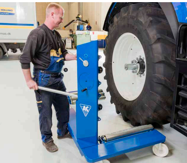
Beim Wiedereinbau kann man die Räder zur perfekten Ausrichtung der Radbolzen drehen.
