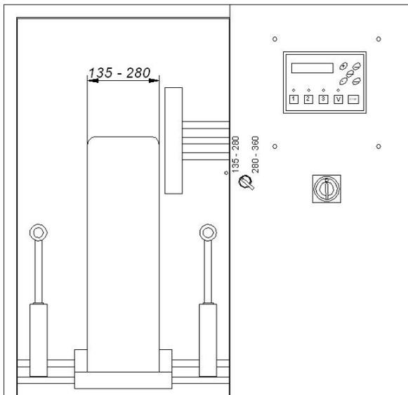
Die Lage **280-360** – die Rolle in der Ruhestellung (abgeschoben) – für Räder mit der Breite von 280-360 mm
