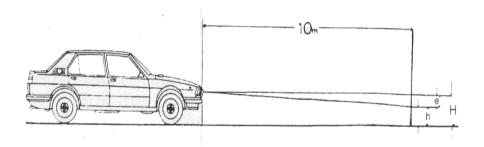
e= Abweichung der Hell-Dunkel-Grenze in cm auf 10 m Entfernung H= Höhe der Scheinwerfermitte über der Standfläche in cm h= Höhe des farbigen Trennstrichs der Prüffläche über der Standfläche in cm
