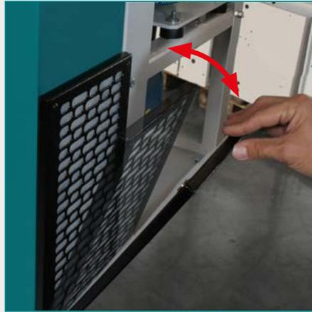
Die RS-PRO ist optional mit Vorsatzfiltergittern zum Schutz vor Verschmutzungen erhältlich. Die Gitter sind durch Magnete sehr einfach anzubringen und ohne Weiteres nachrüstbar.
