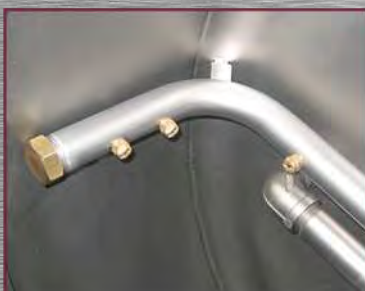
Düsenrohrsystem im Detail
