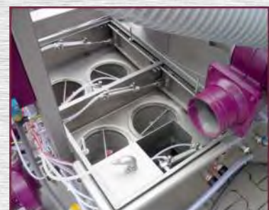
Klappensteuerung und Rücklauffiltersystem
