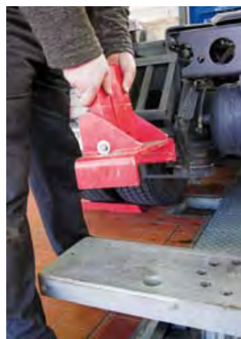
Auswechselbares Aufnahme-Schieber-System zum Anheben verschiedener Fahrzeugtypen.
