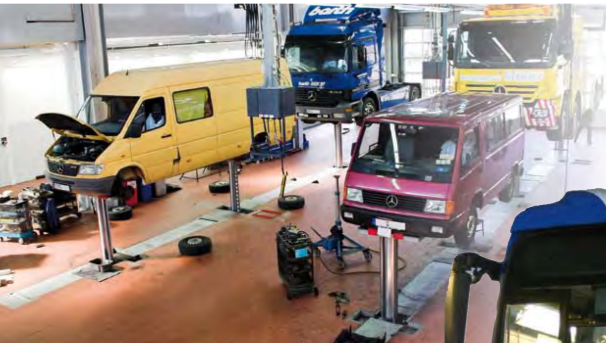
2 HVV Vier-Stempel-Hebebühnen, die als 2 Zwei-Stempel-Hebebühnen benutzt werden.
