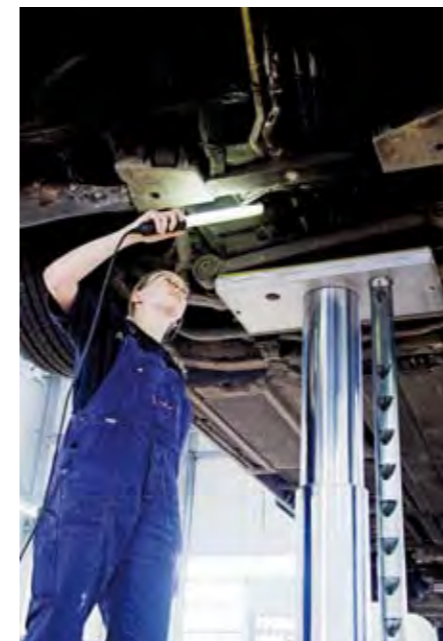
Teleskopstempel mit optionaler Sicherheitsstütze (EN 1493-konform)
