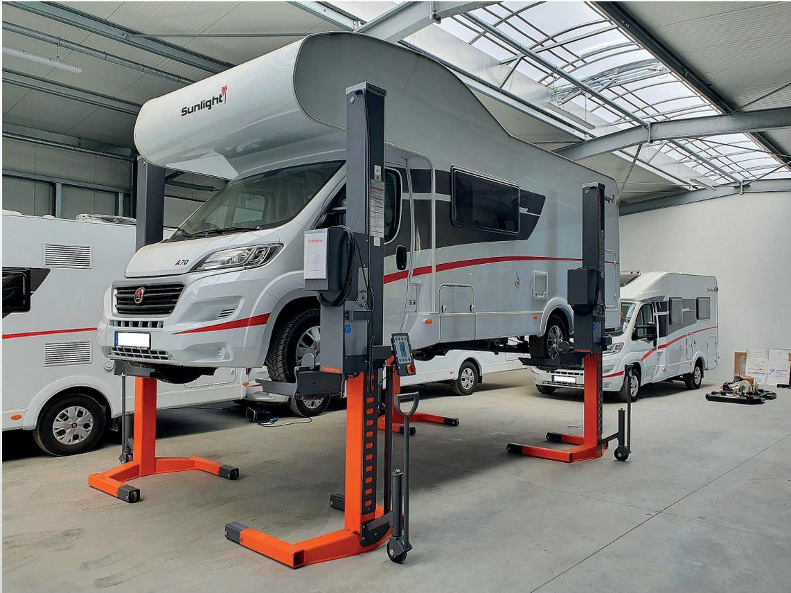
FINKBEINER mobile Radgreif-Hebeanlage für Wohnmobile + NFZ, 4er Anlage, verlängerte Radgabeln, 4 x 3 Tonnen = 12 Tonnen, Radgabel verstellbar für Reifen Ø 550–1140 mm, Länge 500 mm
