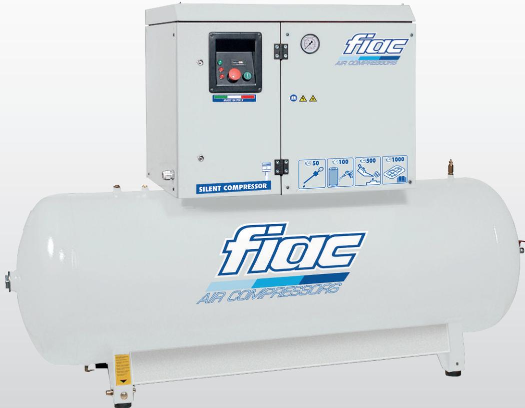
FIAC stationärer geräuscharmer Kolbenkompressor mit Keilriemenantrieb. Vollautomatisch arbeitend mit Zylinder aus Stahlguss. Komplett vormontiert mit Sterndreieckschalter, Druckregler, Manometer, Motorschutzschalter, Riemenschutzgitter und Ölstandsüberwachung.
